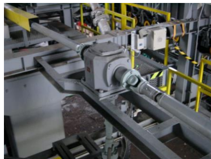
動力伝達軸の分解整備
